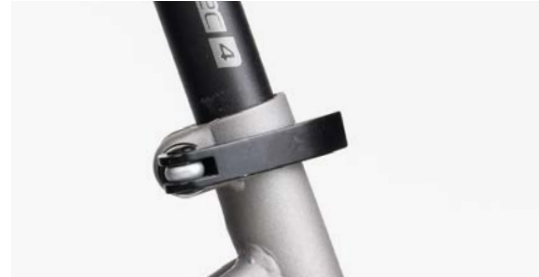
Schnellspanner in geschlossener Position
